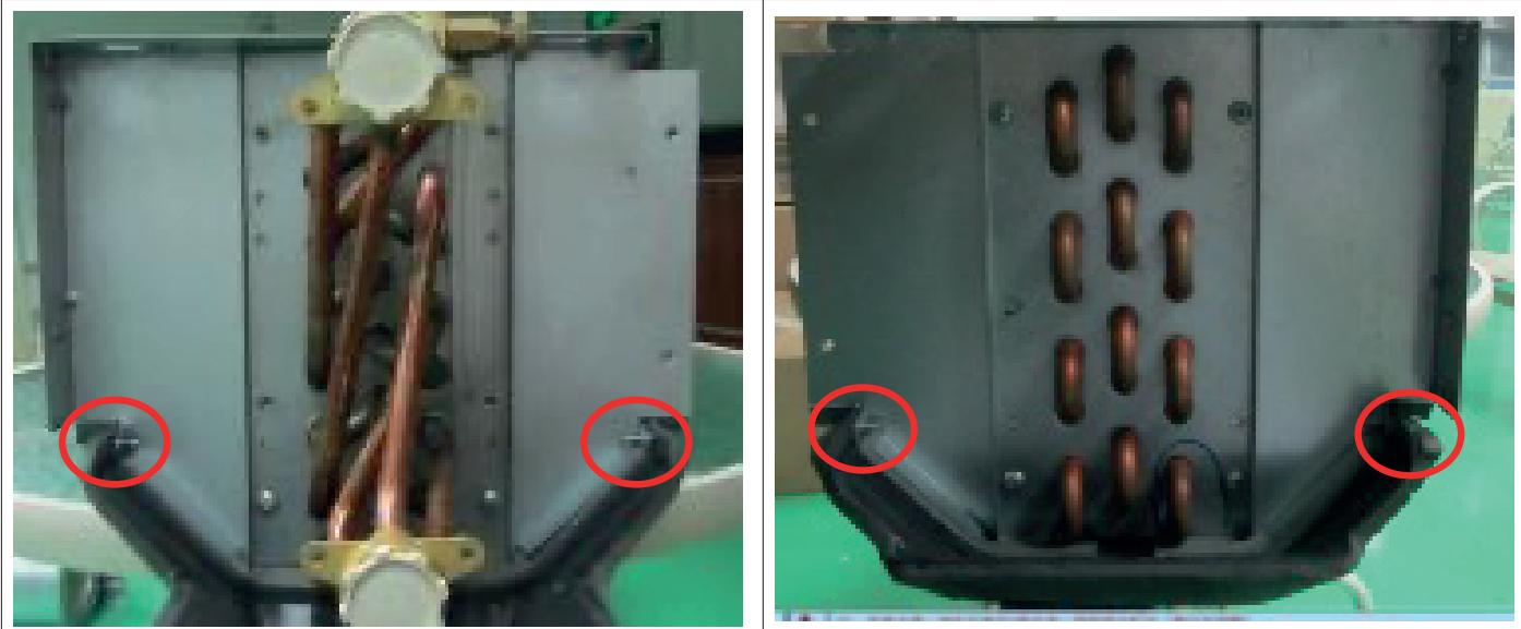
Снимите винты крепления теплообменника
