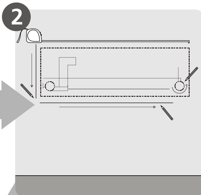
разметка для установки монтажной пластины
