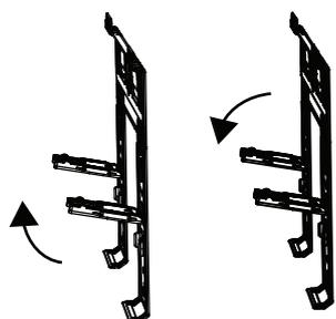
Фиксаторы для удержания внутреннего блока в монтажном положении
