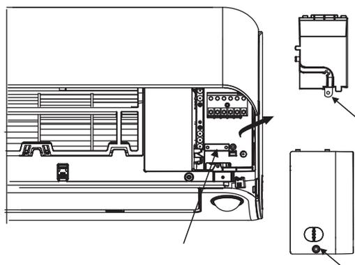
Доступ к клеммникам межблочного кабеля и кабеля э/питания
