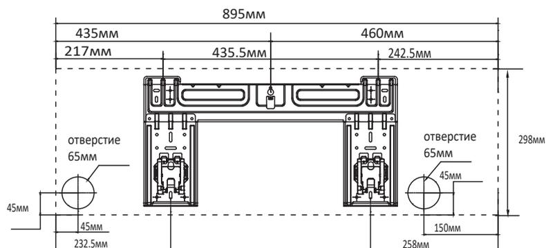
Габариты монтажной пластины, и размещение отверстий для труб хладагента (трассы)
