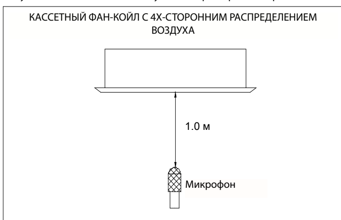
Рисунок №6 Схема испытаний шумовых характеристик агрегатов
